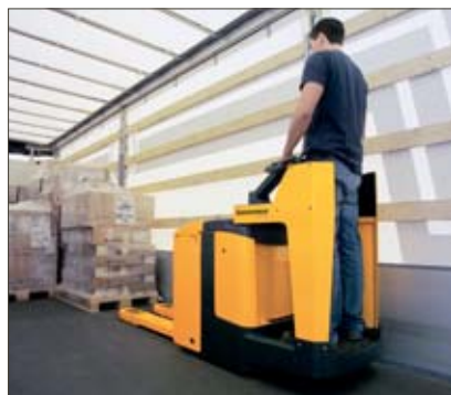
Puesto de mando protegido con plataforma fija
